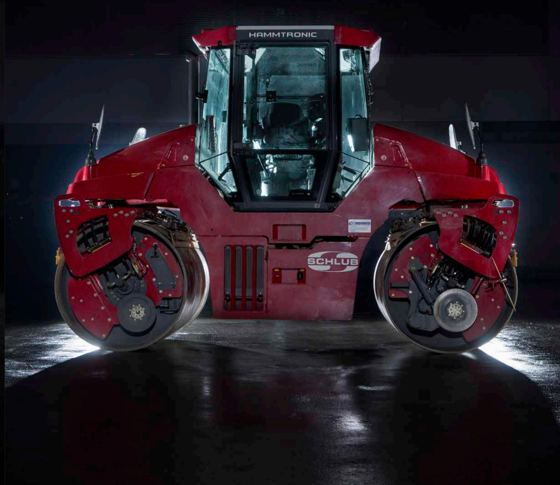
Die **Oszillationswalze Hamm DU 90** stellt sich dank innovativer Technik innerhalb von 10 Millisekunden auf veränderte Bodenbedingungen ein (entspricht einer Fahrstrecke der Walze von 1 cm). Durch die statische Auflast und die wechselnden dynamischen Scherkräfte im Material erfolgt eine schnellere, bessere und schonendere Verdichtung.
