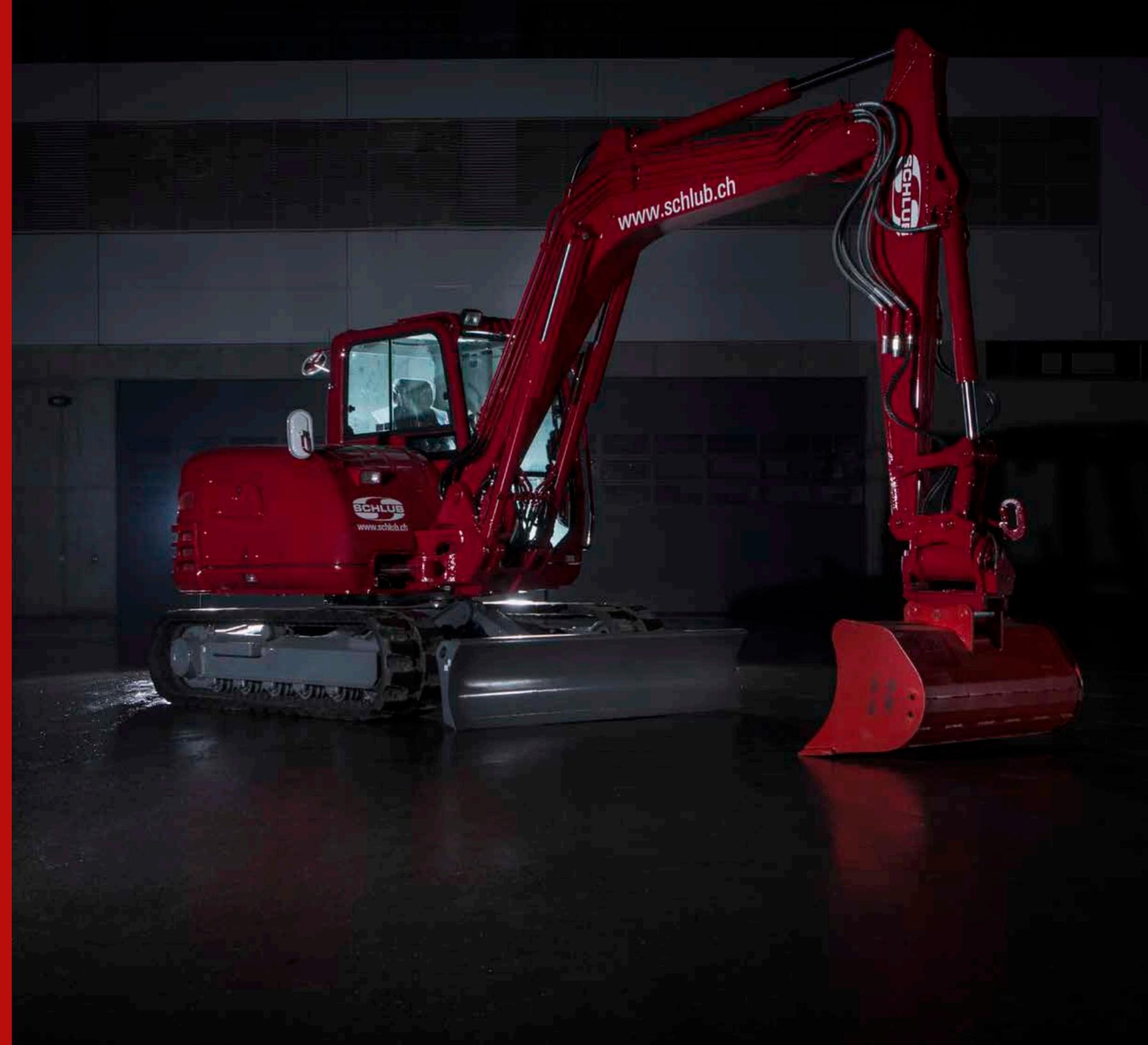
**Takeuchi Kompaktbagger TB 180 FR** Wenn es allen anderen Maschinen im Einsatz zu eng wird, laufen die Zero Tails von Takeuchi zu ihrer Höchstform auf. Die kompakten Zero Tails begeistern mit Kraft, Beweglichkeit und höchstem Komfort. Der seitlich platzierte Motor und die Tanks ermöglichen beste Ausführungsqualität auf engstem Raum.
