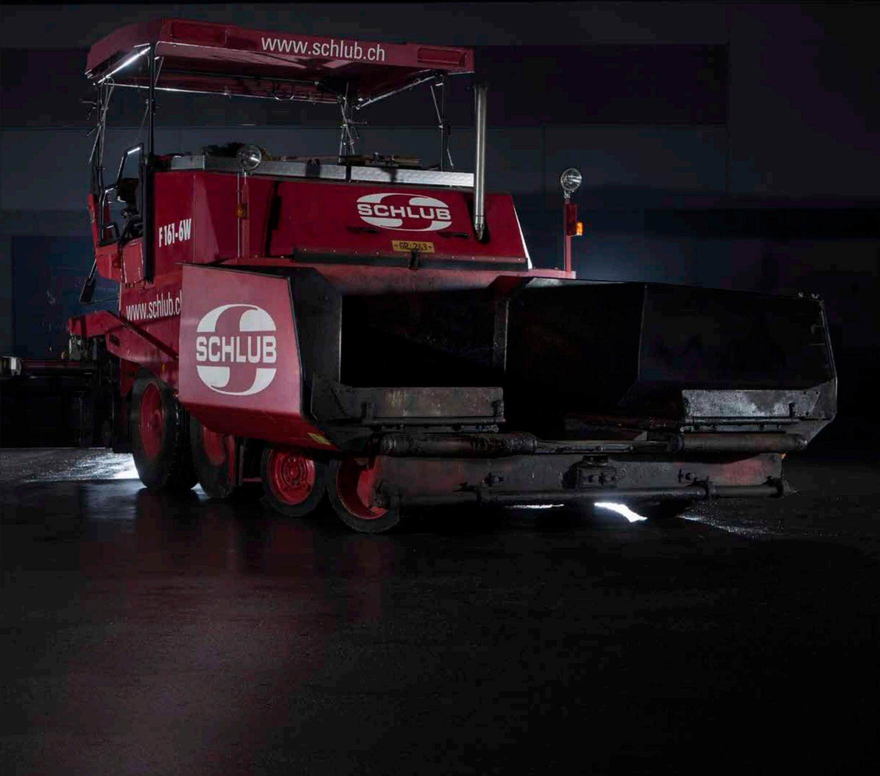
Der **Strassenfertiger Dynapac F161-6W** vereint Leistungsstärke mit höchster Flexibilität. Der sparsame Motor verfügt über grosse Kraftreserven und sorgt für eine gleichbleibende Verdichtung des Materials auch unter schwierigeren Bedingungen.
